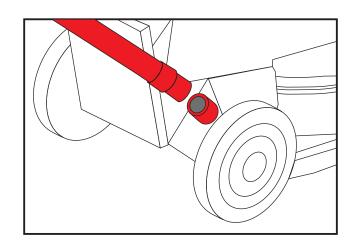
THE VACUUM HOSE PORT IS SITUATED ON THE BACK OF THE MACHINE.
